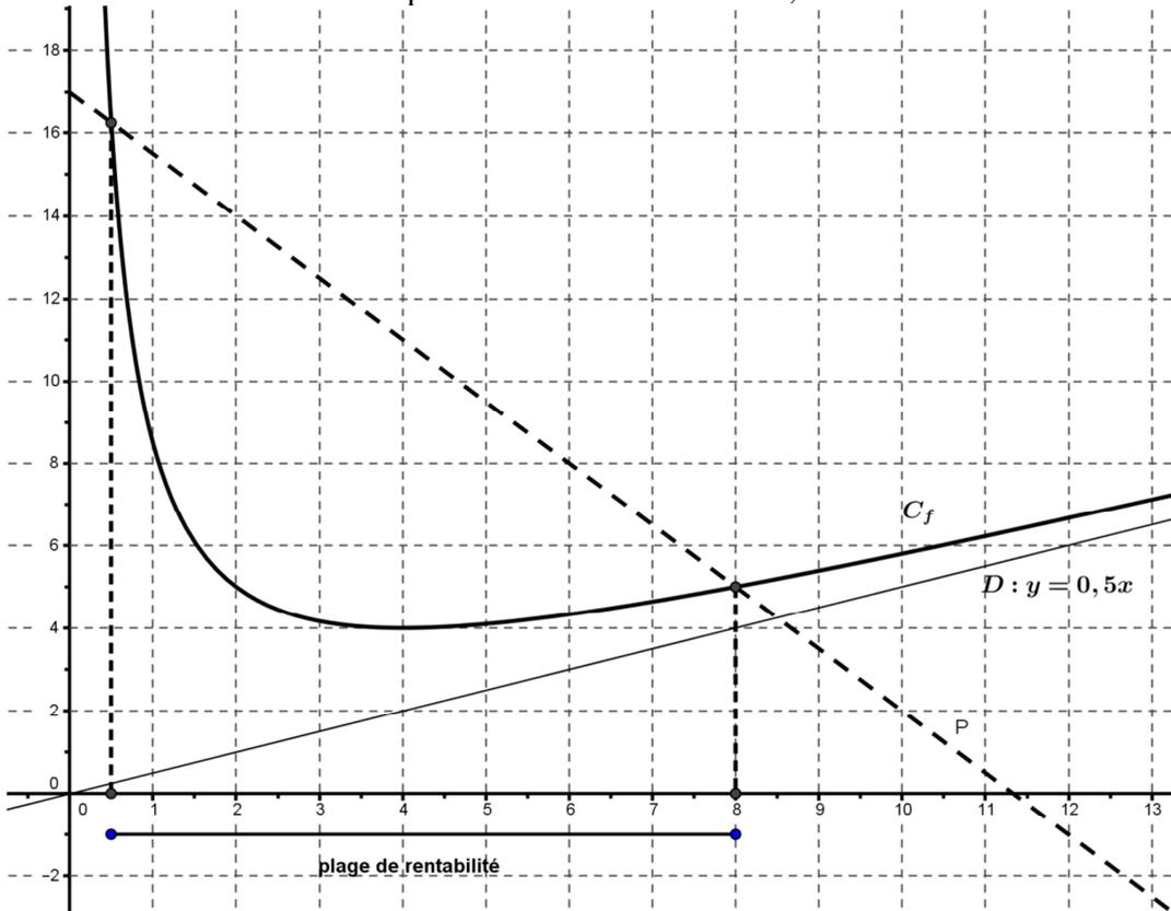
Pour tracer D : pour  $x = 0$   $y = 0,5 \times 0 = 0$     pour  $x = 8$   $y = 0,5 \times 8 = 4$
